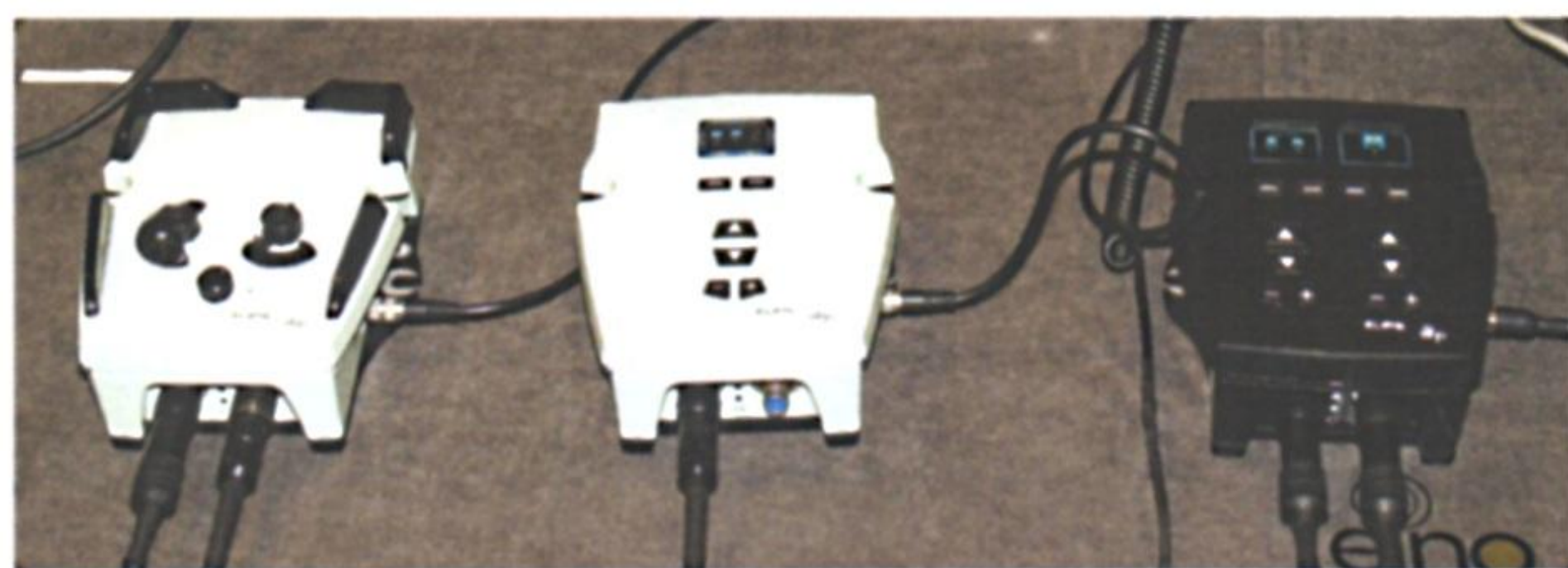
Sopra: il rendering del sistema di visione a 360° e allarme laser ANTARES sviluppato da Thales, società che fornisce anche il sistema vetrone di tutti i veicoli del programma SCORPION. (foto: Thales). Sotto: gli elementi del sistema interfonico ELIPS, basato sulla tecnologia IP, sviluppato da Elna per SCORPION. (foto: Autore)
