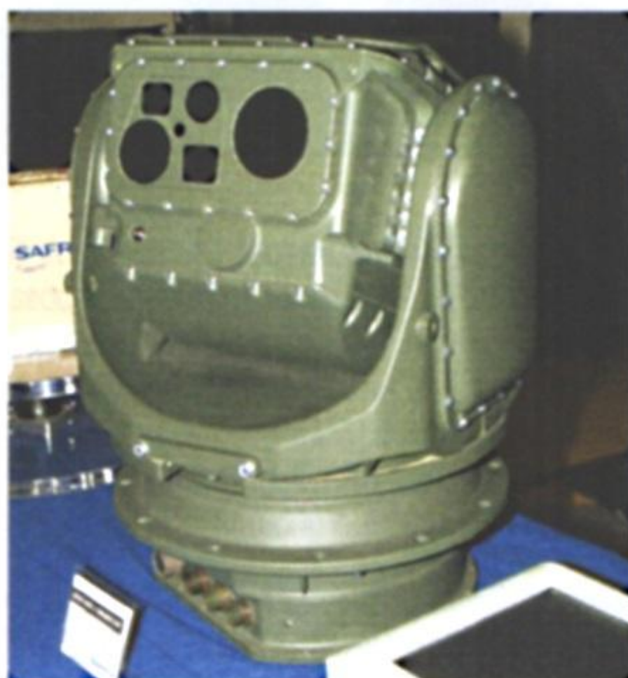
Per il JAGUAR Sagem fornirà il sistema PASEO, che comprende un canale termico, uno televisivo HD e un telemetro laser; sarà usato sia come sistema di puntamento per il cannoniere che come visore periscopico per il capocarro. (foto: Autore)
