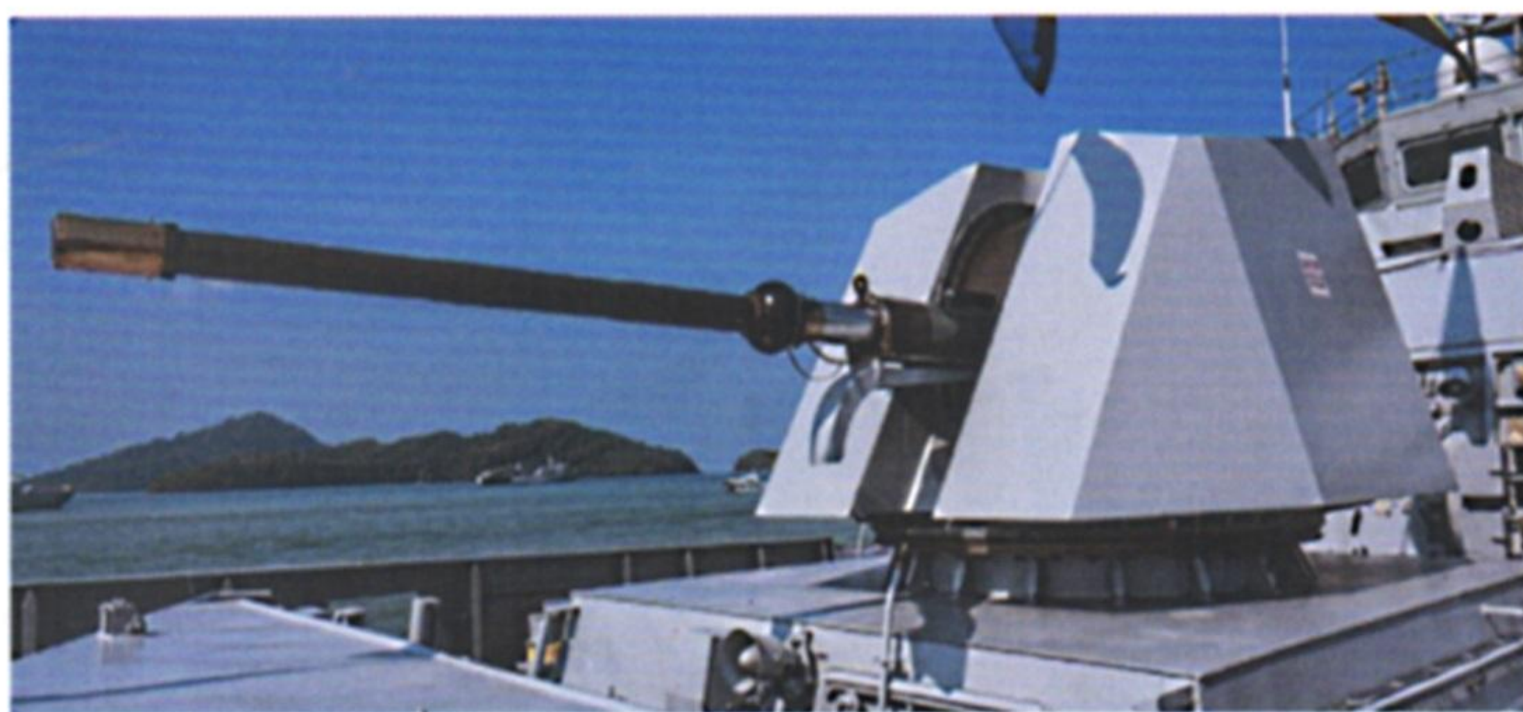
La torre Leonardo (Divisione Sistemi di Difesa) da 76/62 mm della KAMORTA. Sotto: una delle 2 torrette AK-630 da 30 mm.
