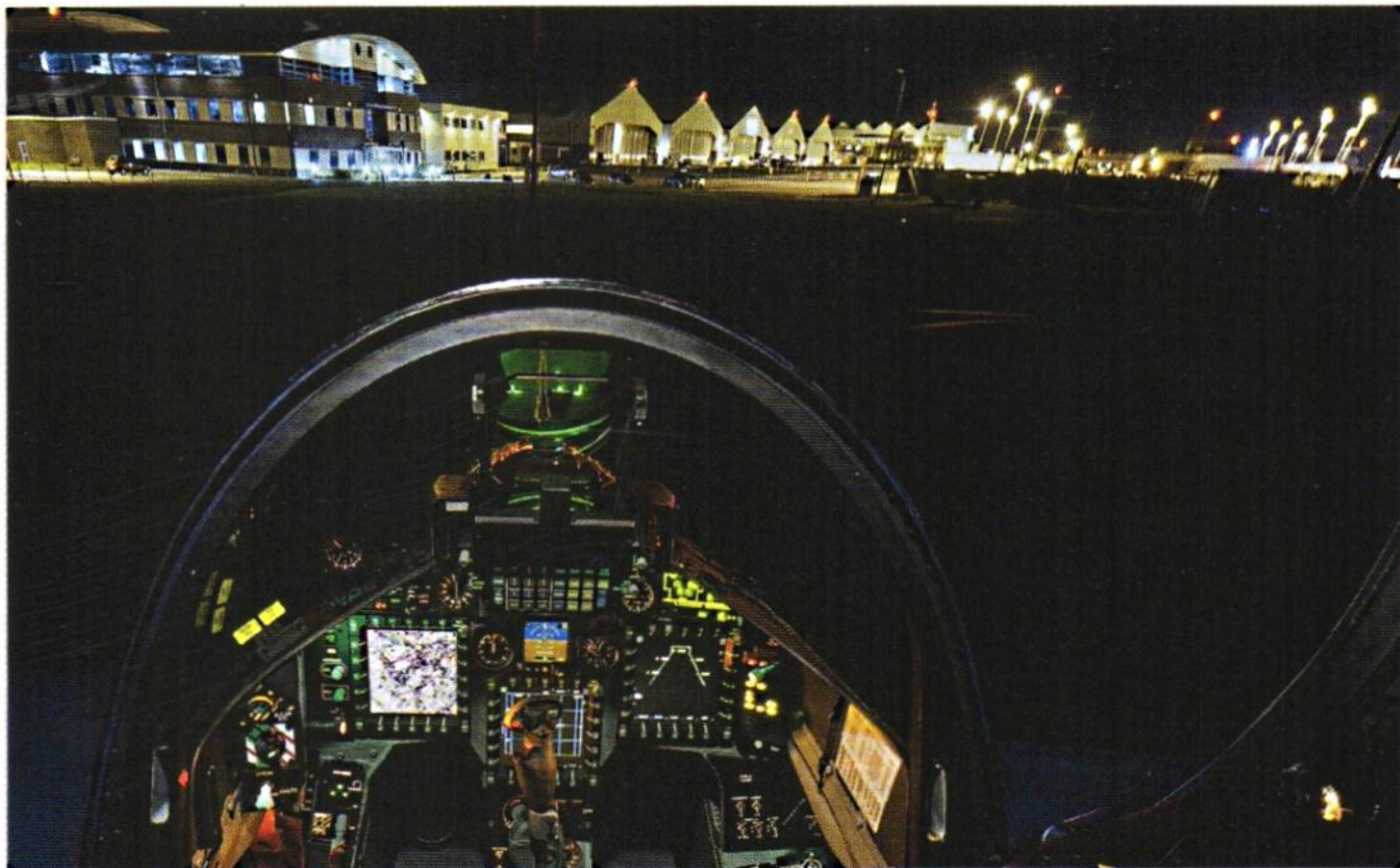
Il cruscotto dell'HAWK T-2 equipaggiato per la simulazione di radar, di RWR, di sistemi di autodifesa e di missili aria-aria.
