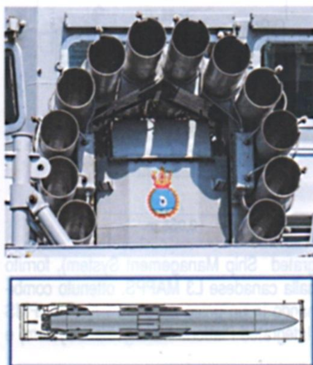
Sopra, al centro: uno dei 2 lanciarazzi ASW RBU-6000. Sopra: il missile sup/aria BARAK 1. Sotto: il sistema missilistico sup/aria BARAK 1 in tutti i suoi componenti.
