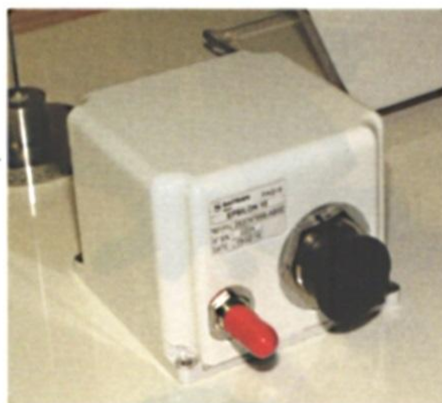
Il sistema di navigazione inerziale Epsilon 10 di Sagem, di cui saranno dotati tutti i veicoli GRIFFON. I JAGUAR, che necessitano di una maggior precisione, verranno invece equipaggiati con la piattaforma SIGMA 20, sempre di Sagem. (foto: Autore)
