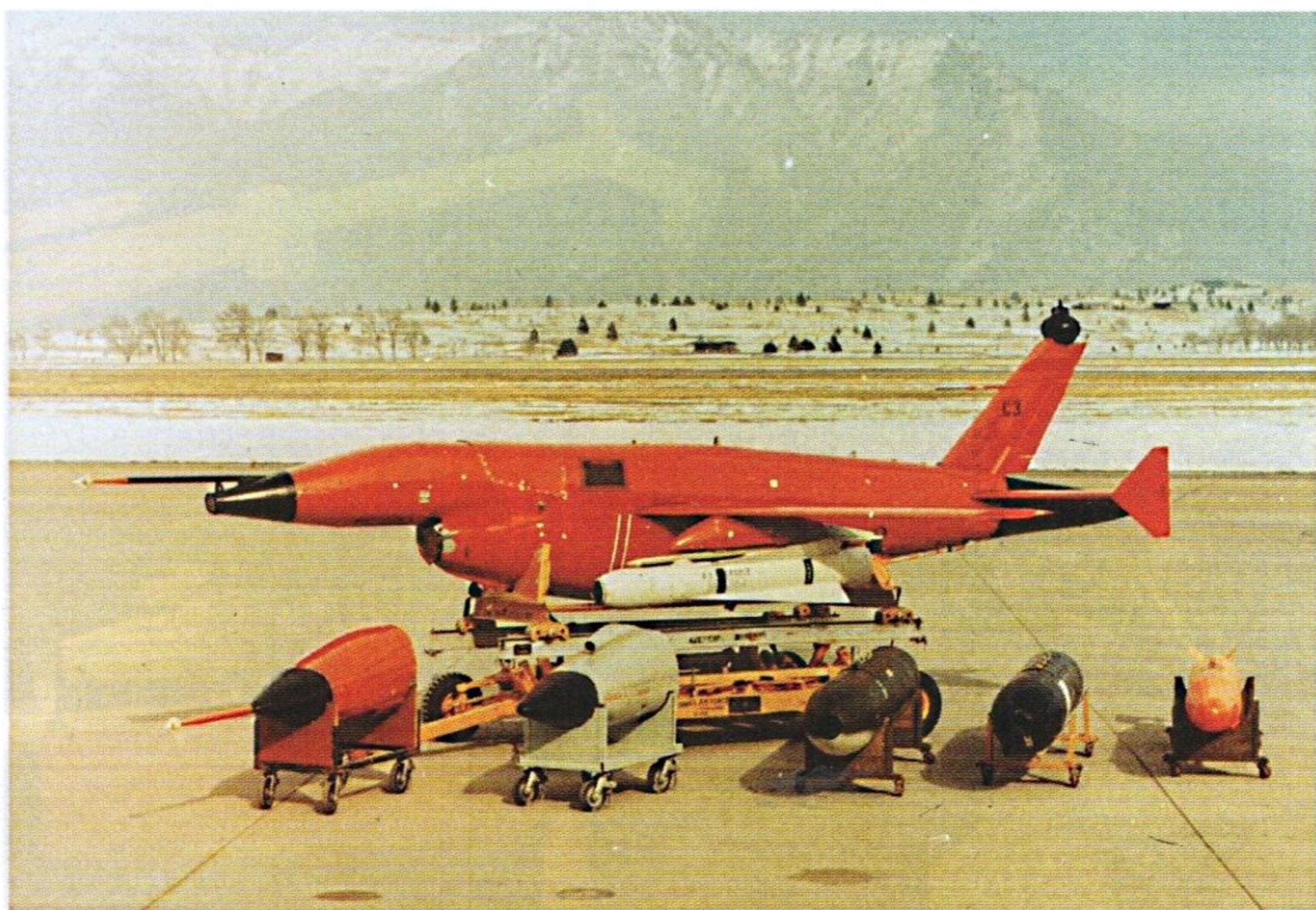
Il sistema BGM-34C al completo; il velivolo è configurato in versione armata, mentre in primo piano sono visibili da sinistra i musetti da ricognizione, da guerra elettronica, i dispenser di chaff ALE-38 e ALE-2 e quindi un serbatoio supplementare subalare da 250 litri.
