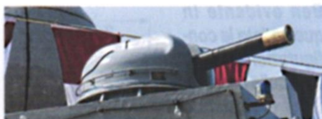
La torre Leonardo (Divisione Sistemi di Difesa) da 76/62 mm della KAMORTA. Sotto: una delle 2 torrette AK-630 da 30 mm.
