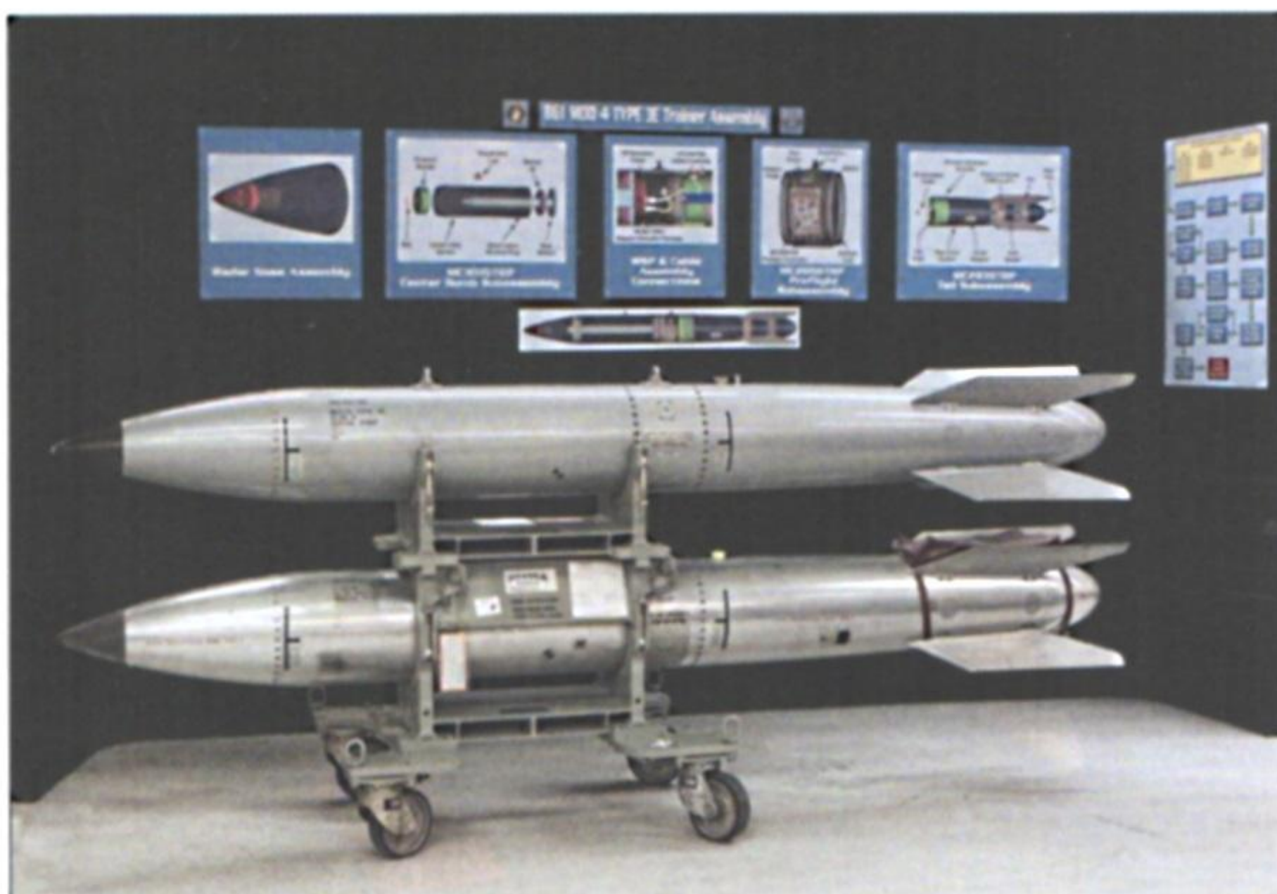
B-61-4 da addestramento; sulla parete sono visibili i pannelli esplicativi delle varie parti che compongono la bomba.
