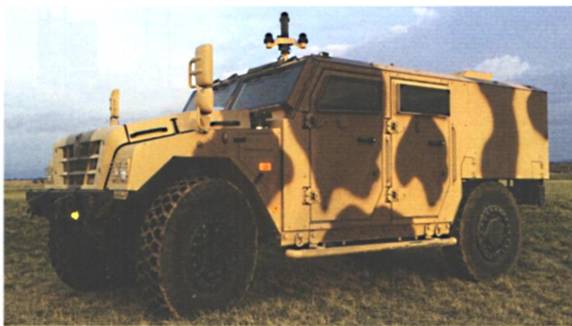
Il sensore del PILAR V installato su uno SHERPA di RTD. Il sistema di rilevamento acustico è già in servizio con l'Armée de Terre a bordo dei VAB aggiornati impiegati nell'ultima fase della missione in Afghanistan. (foto: Metravib)
