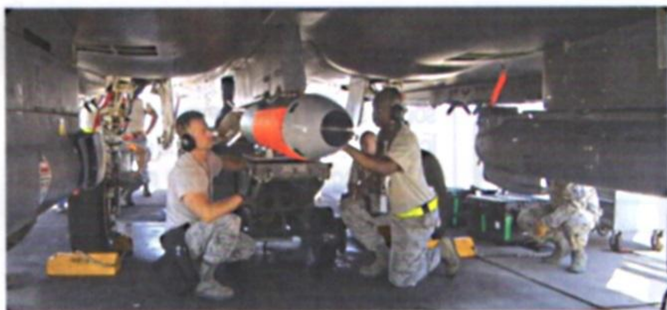
La B-61-12 di prova montata al pilone ventrale dell'F-15E (a sinistra), velivolo usato per le prime prove di sgancio (a destra).
