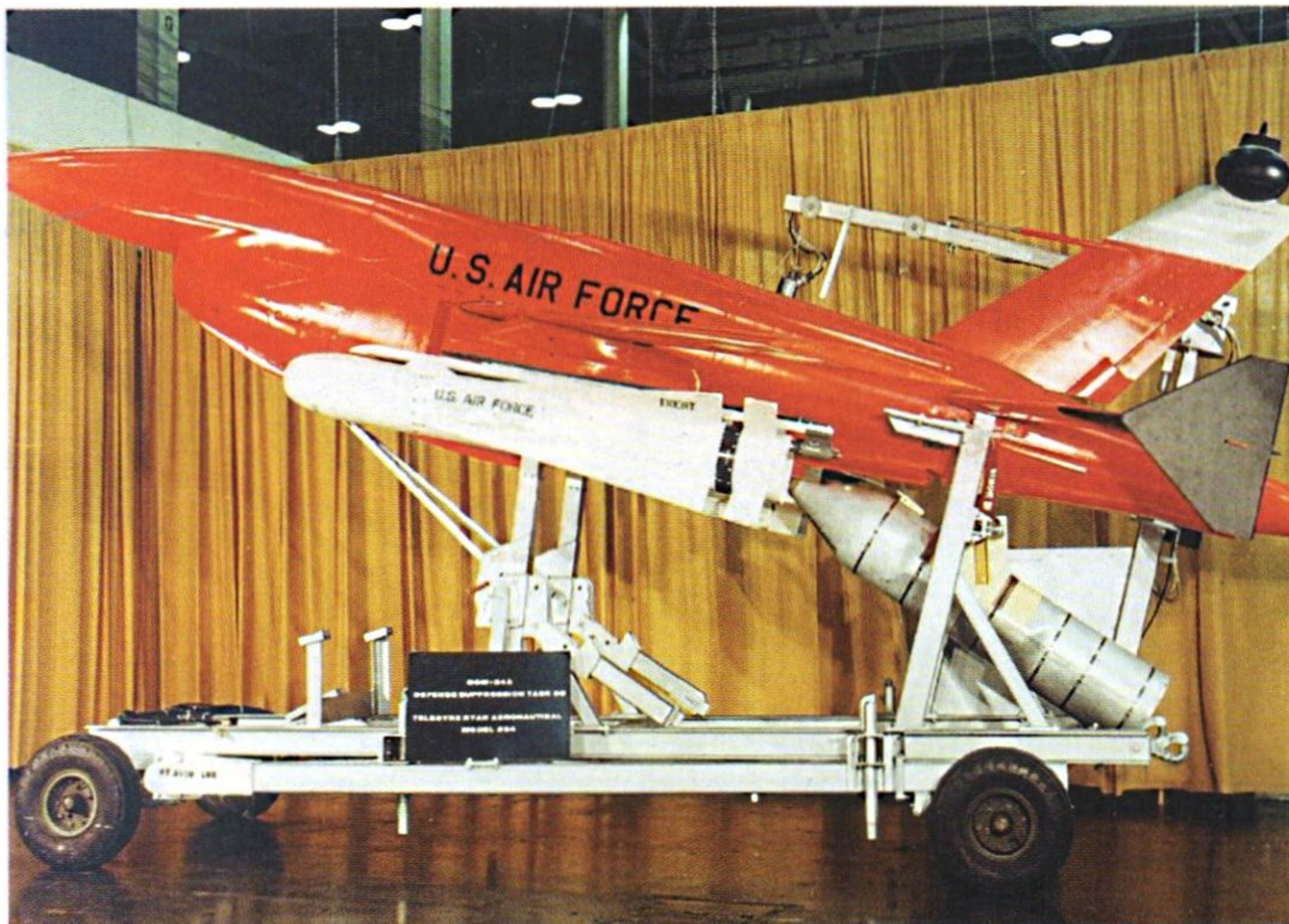
La presentazione ufficiale del BGM-34A, sviluppato dalla Teledyne Ryan all'interno del progetto HAVE LEMON per la soppressione delle difese aeree.
