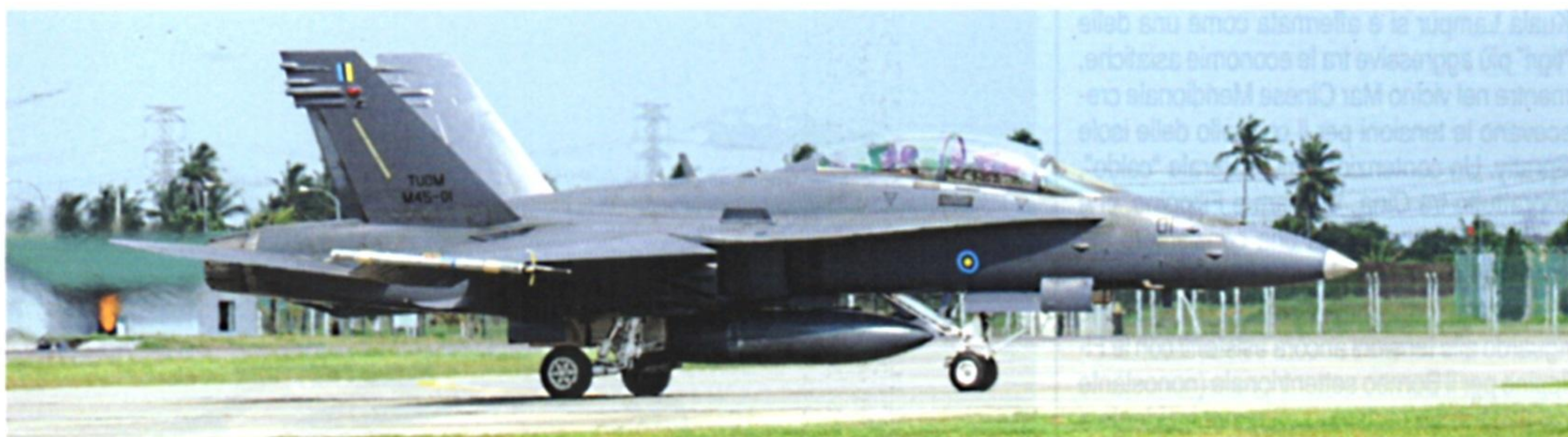
F/A-18D HORNET in esercitazione: per 6 di questi aerei è stato avviato un MLU che comprende nuova avionica e l'integrazione di bombe laser GBU-10, GBU-12 e GBU-16.
