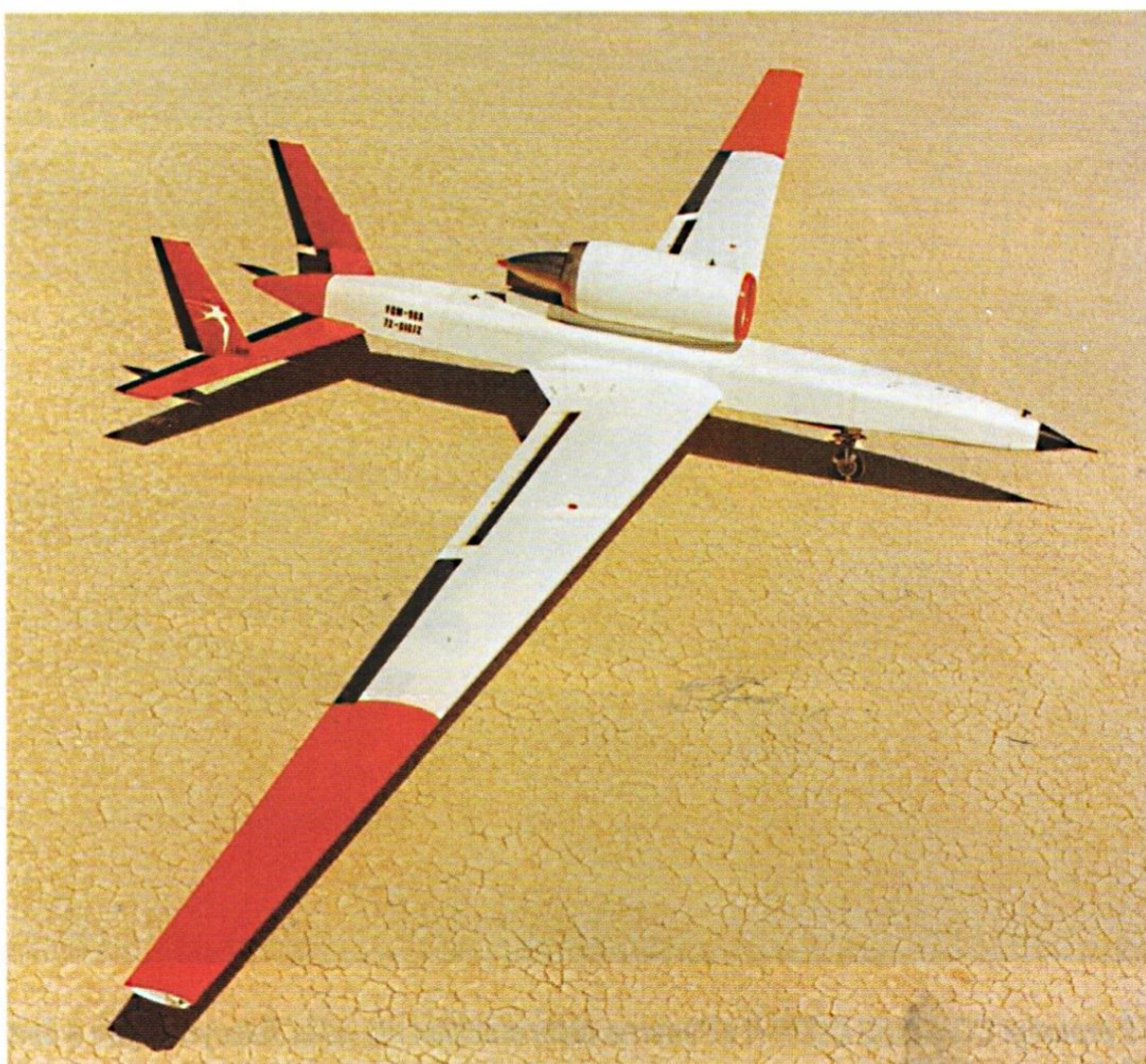
Una vista dall'alto del Teledyne Ryan YQM-98A COMPASS COPE-R, in cui si evidenzia la grande apertura alare.
