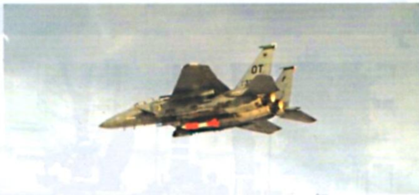
La B-61-12 di prova montata al pilone ventrale dell'F-15E (a sinistra), velivolo usato per le prime prove di sgancio (a destra).
