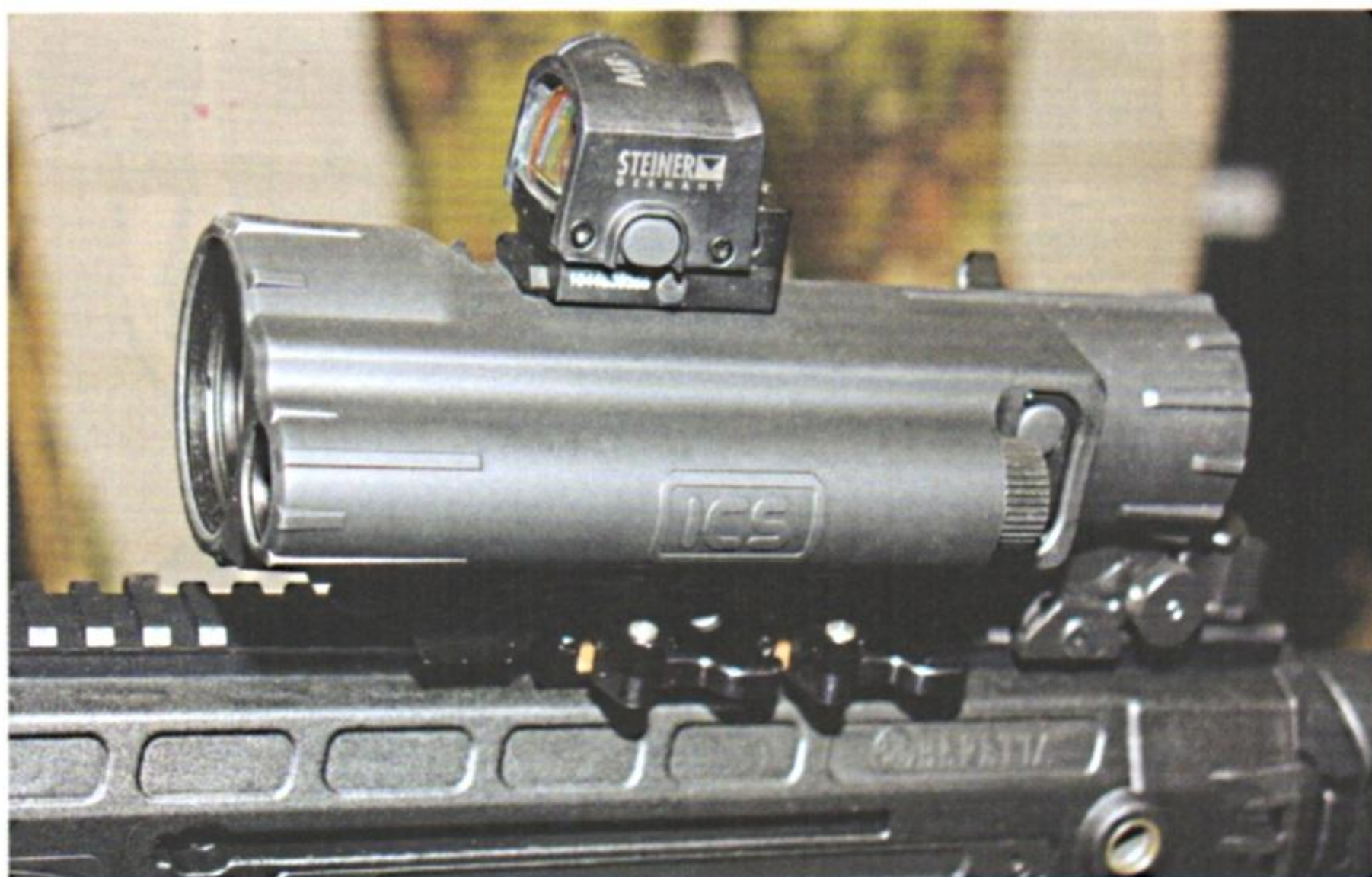
Lo Steiner ICS (Intelligent Combat Sights) 6x40 consente rapide misurazioni della distanza del bersaglio e immediata compensazione balistica a seconda della munizione usata.
