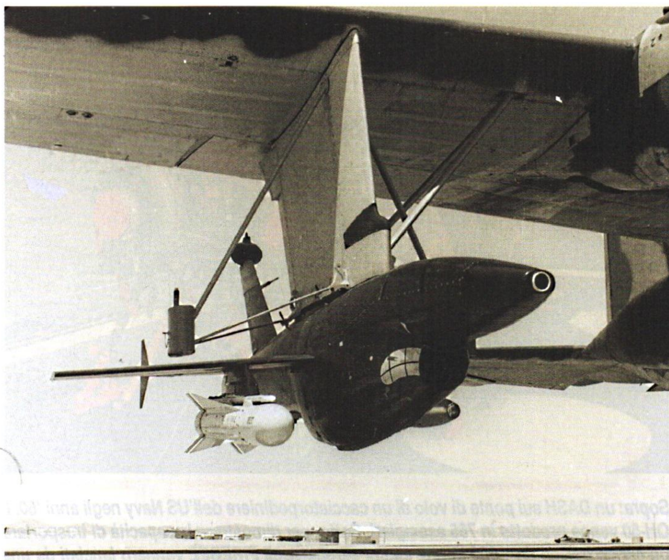
Uno dei primi BGM-34 impiegati per i test sul lancio di armamento di caduta. L'apertura nel muso contiene una camera TV dotata di zoom per il controllo remoto del velivolo. Agganciato al pilone dell'ala destra vi è un missile MAVERICK a guida elettro-ottica.
